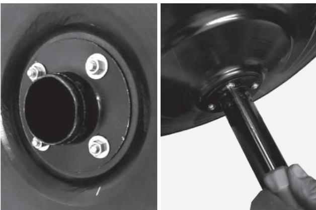
**e.** Coloque el motor con su acople sobre el barral. Procure hacer coincidir el orificio del barral alineado con la posición donde se encuentra el tornillo de fijación en el acople del motor. Luego atornille el tornillo para fijar el motor al barral. Note que debe atornillar 3 tornillos.
