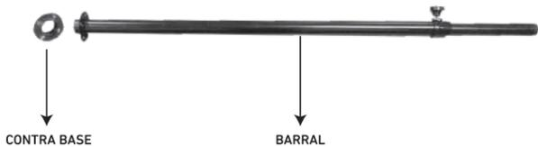
**b.** Coloque el barral sobre la base haciendo coincidir los orificios de los tornillos de la base con los del barral.
